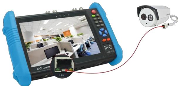
**Napomena:** 1) Ako IP kamera zahtijeva PoE napajanje, spojite IP kameru na LAN priključak za IP tester. Tester će isporučiti PoE snagu za IP kameru. Kliknite na ikonu POE da biste isključili ili uključili PoE napajanje.
